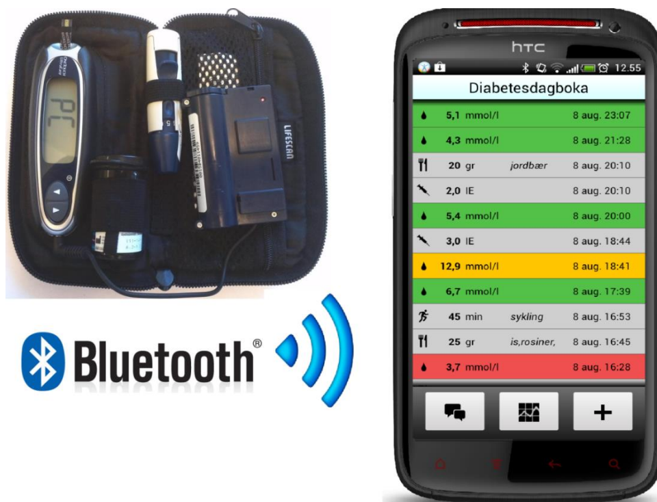
Bilde 6: Måleapparat med Bluetoothoverføring til telefon
